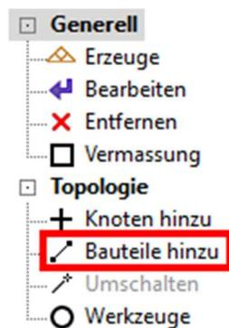
Klicken Sie auf das linke Ende der unteren geneigten Linie, dann auf deren rechtes Ende. Dies erzeugt den Untergurt des Binders:
