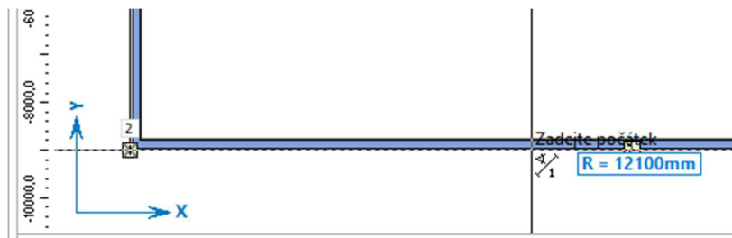
Počátek zadávání konstrukčních čar vzniklý trasováním z bodu 2
