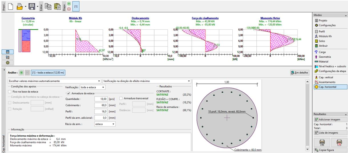
Janela “Capacidade de carga horizontal” – Distribuição linear do módulo de reação horizontal do subsolo  $k_h$ , deformação e forças internas
