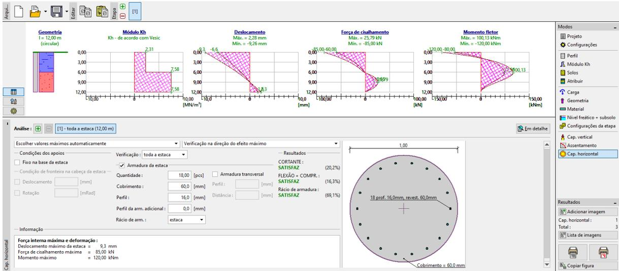
Janela “Capacidade de carga horizontal” – Distribuição do módulo de reação horizontal do subsolo  $k_h$  segundo Vesic, deformação e forças internas
