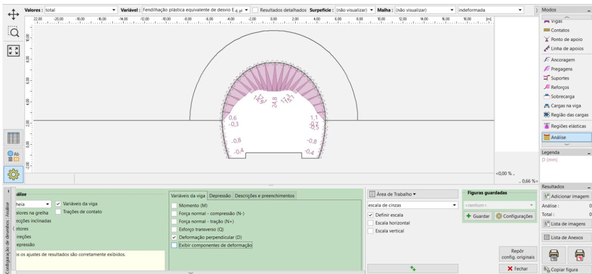
Janela “Análise” – Etapa de construção 7 (deformação perpendicular)
