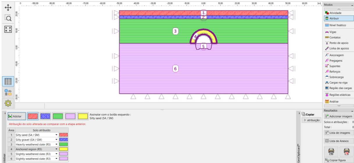
Janela “Atribuir” – Etapa de construção 3 (região ancorada com roquetes expandidos hidráulicamente)
