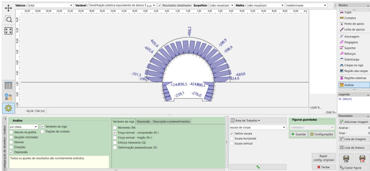
Janela “Análise” – Etapa de construção 7 (força normal – compressão  $N^-$  [kN/m])
