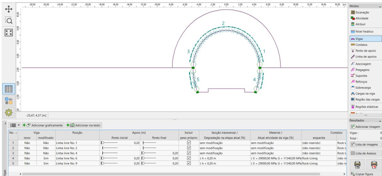
Modificação das propriedades do revestimento primário (base do túnel) – Etapa de construção 7 (concreto maduro projetado)
