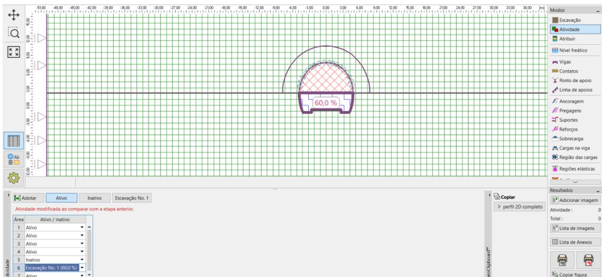
Janela “Atividade” – Etapa de construção 5 (atividade de 40 % da carga na escavação da base do túnel)
