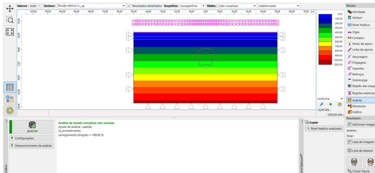
Janela “Análise” – Etapa de construção 1 (tensão geostática primária  $\sigma_{z,eff}$ )
