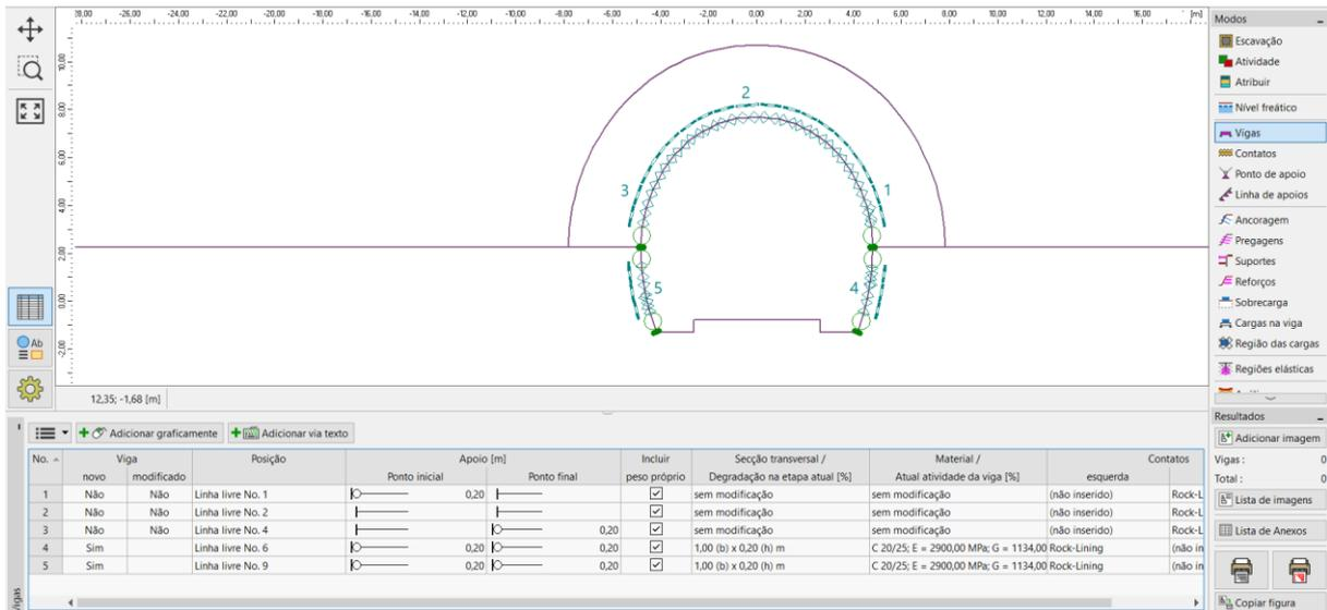
Introdução do revestimento primário da base do túnel através de novas vigas – Etapa de construção 6 (concreto imaturo)
