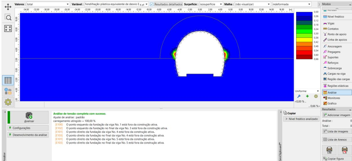
Janela “Análise” – Etapa de construção 7 (deformação plástica equivalente  $\epsilon_{eq.,pl.}$ , segundo o modelo de Mohr-Coulomb)
