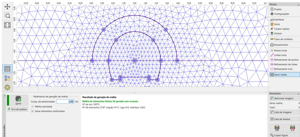
*Janela “Geração da malha” – Refinamento dos pontos na vizinhança da região escavada (comprimento 0.5 m)*
