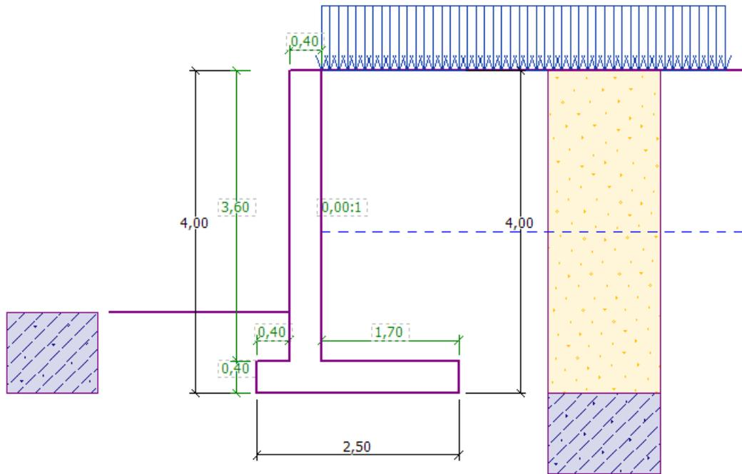
FIGURE 1 – Schéma du mur cantilever – Projet
