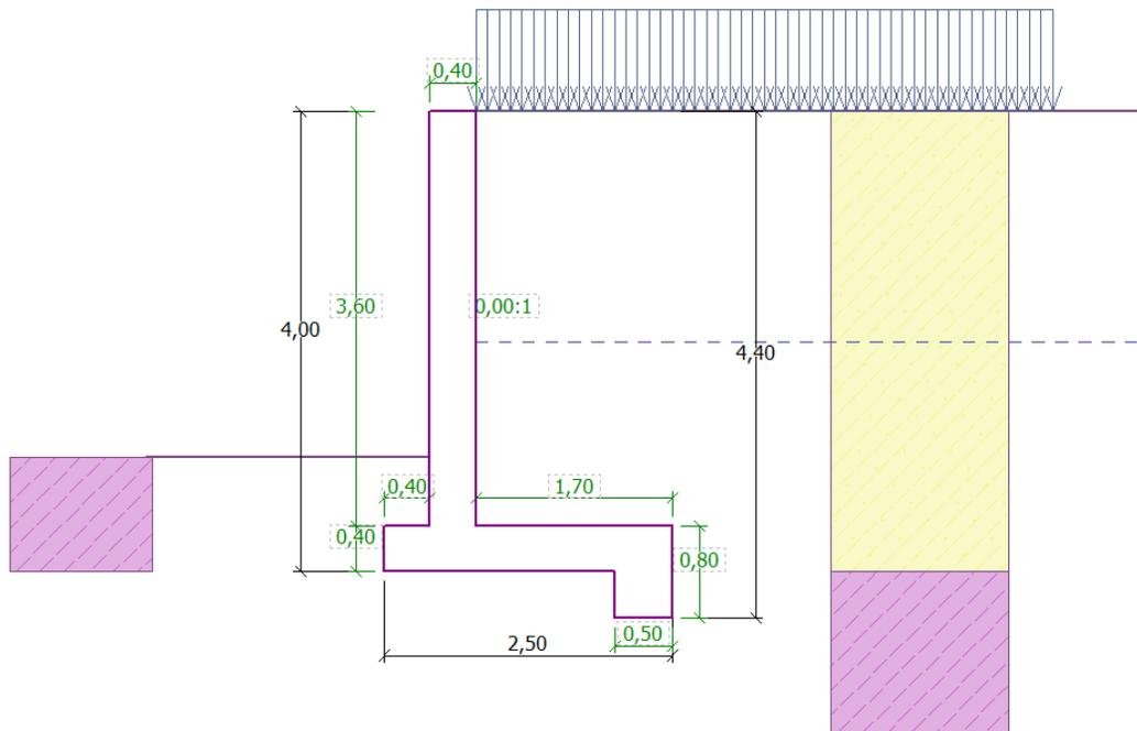
FIGURE 18 – Nouvelle forme de la structure
