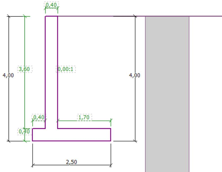
FIGURE 4 – Cadre « Géométrie » - Schéma du mur cantilever
