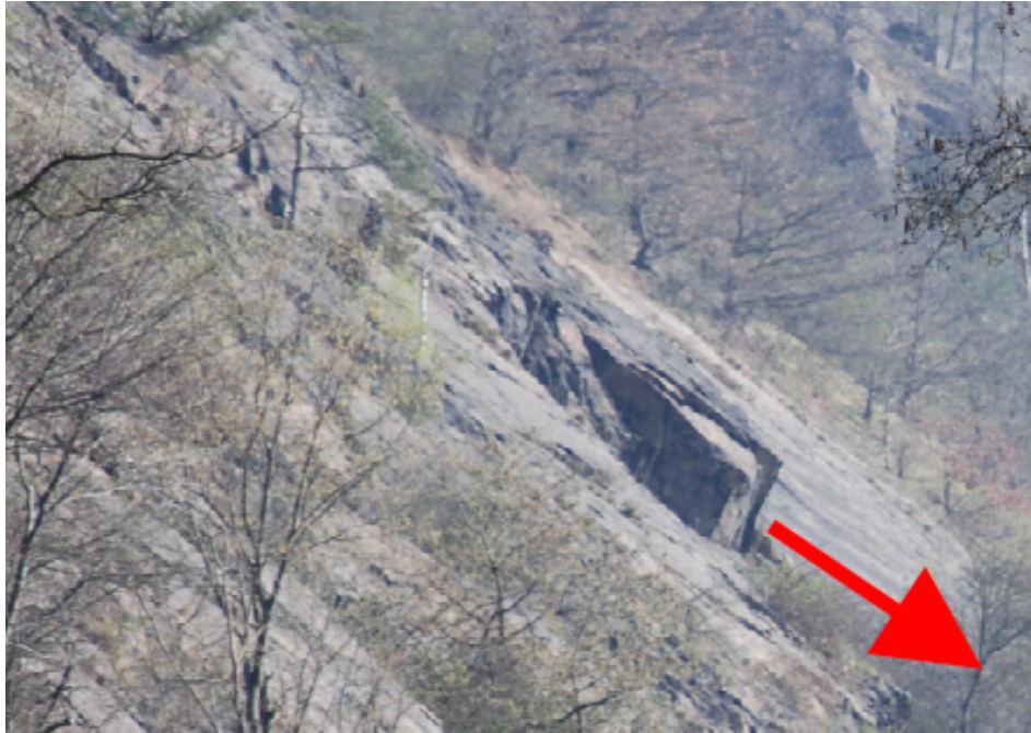
FIGURE 4 – Bloc rocheux avec présomption de mouvement de translation (photo Vaníček 2009)
