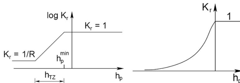
*Evolución del coeficiente de permeabilidad relativa como función de la carga de presión para los modelos Log-lineal y van Genuchten de zona de transición*
