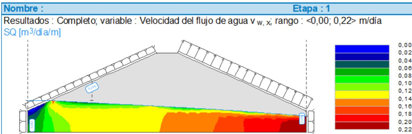
Distribución de la componente horizontal de la velocidad del flujo de agua
