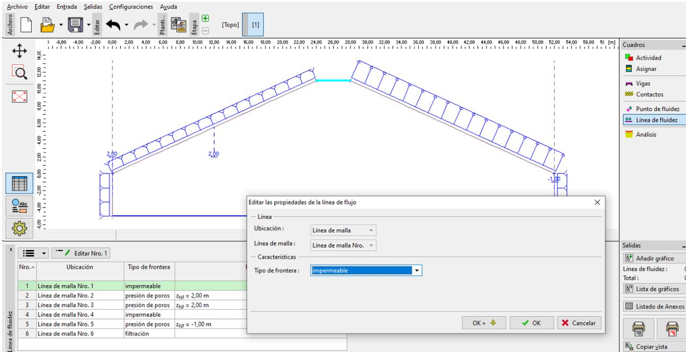
Especificación del flujo lineal (condiciones límite)
