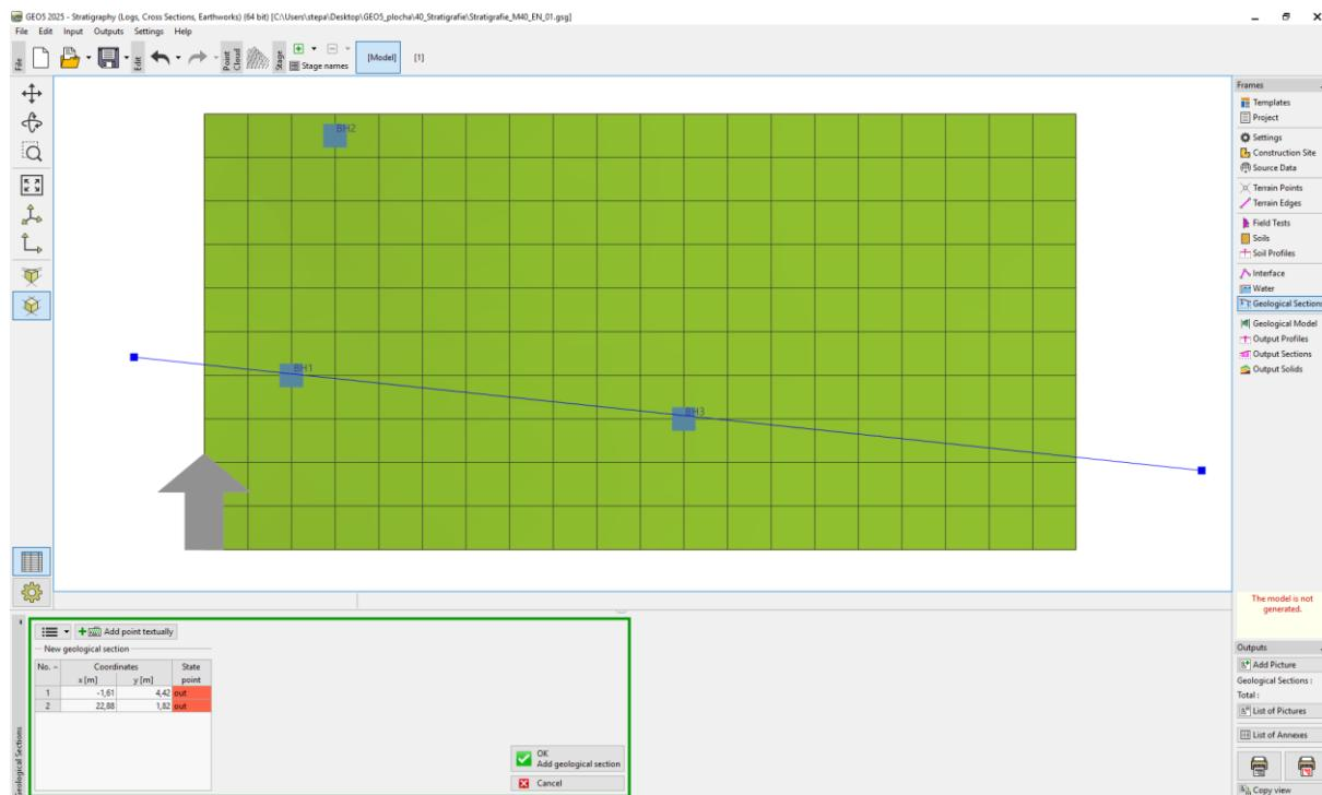
Nakon unosa, presjek je prerezan gabaritima gradilišta i otvara se u dijaloškom prozoru za uređivanje – u kartici “Topology”. Ovdje, dodjeljujemo ispitivanja koja želimo prikazati na našem poprečnom presjeku.
