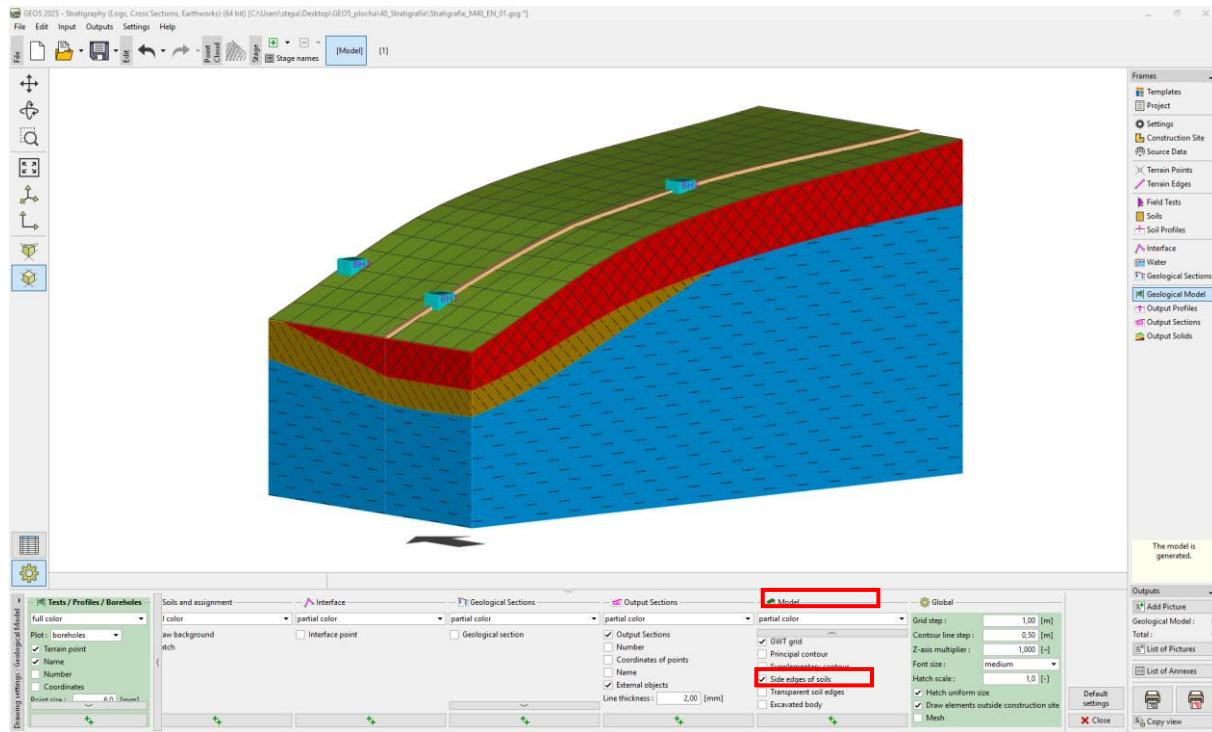
Izrađeni model slojeva slijedi se može dalje modificirati koristeći nove bušotine. Na primjer, pretpostavljamo da će sloj zapunjena s prednje strane biti konstantan. Možemo napraviti ovu preinaku dodavanjem nove bušotine.
