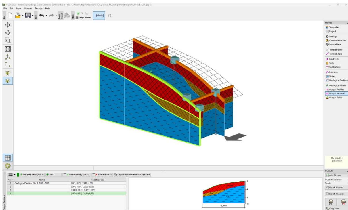
Izrađeni presjeci se mogu kopirati u druge GEO5 programe. Otvorit ćemo izrađeni presjek i kopirati ga u međuspremnik klikom na tipku "Copy output section to Clipboard".
