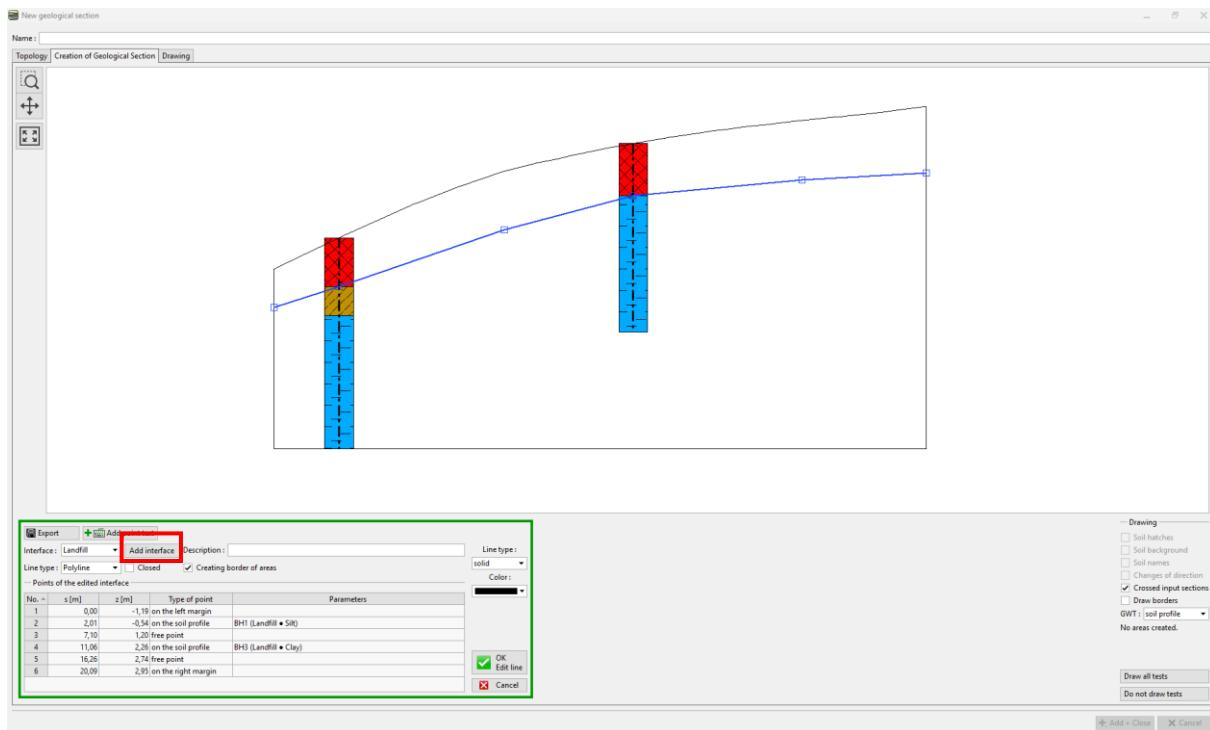
Definirat ćemo granicu između mulja i gline na isti način. Ne zaboravite izraditi novu granicu "Silt - Clay"
