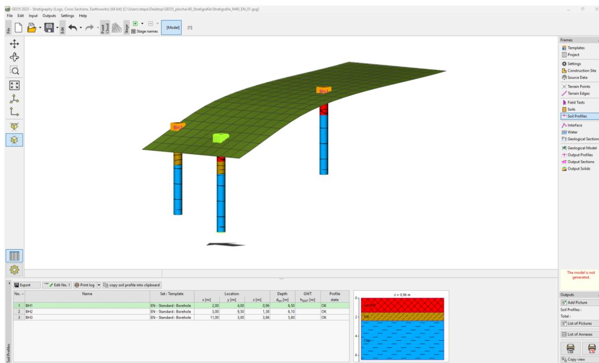
Napomena: Razlog postojanja profila tla je sličan kao i za "Soils". Kompleksne i detaljne bušotine se moraju pojednostaviti za geomehanički model. Penetracijski testovi (CPT, SPT) se također mogu interpretirati u geološke profile. To se može odraditi ili u ovoj kartici ili prilikom izrade geoloških presjeka. Izrada profila tla iz terenskih ispitivanja je opisana u priručniku EM broj 43 – Izrada profila tla iz terenskih ispitivanja.
