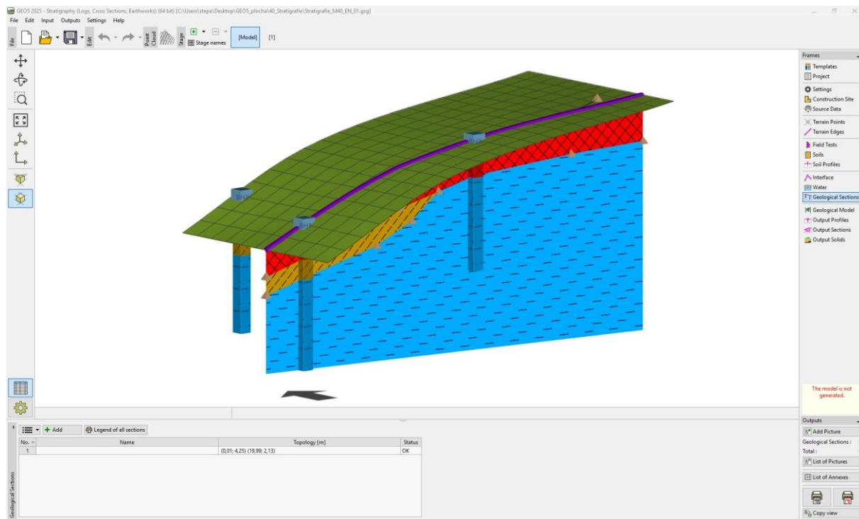
U kartici "Geological Model" odabiremo opciju "Master Borehole". Glavna bušotina određuje broj i redoslijed tla u modelu. Ova bušotina mora sadržavati sva tla u modelu. U tablici zadajemo granice tla koje smo definirali tijekom izrade geološkog presjeka.
