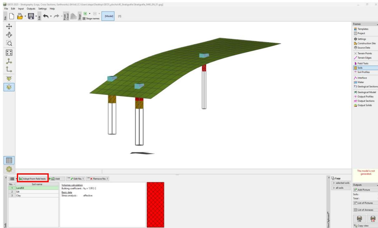
Napomena: U stvarnom geološkom ispitivanju možemo imati velik broj tla s minimalnim razlikama. Za geotehnički model, dovoljno je ujediniti ta tla u "Geomechanical type" i raditi s njima. Tla (geomechanical types) koja ovdje unosimo, će se koristiti ne samo u 3D modelu slojeva tla, već će se također prenijeti i u ostale GEO5 programe.
