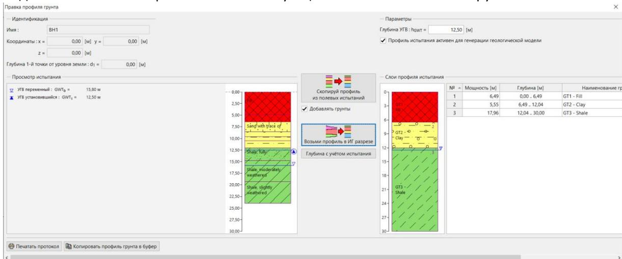
Повторим тоже самое для испытаний СРТ. Это может быть сделано на глубину модели (ниже) или только на глубину полевых испытаний.
