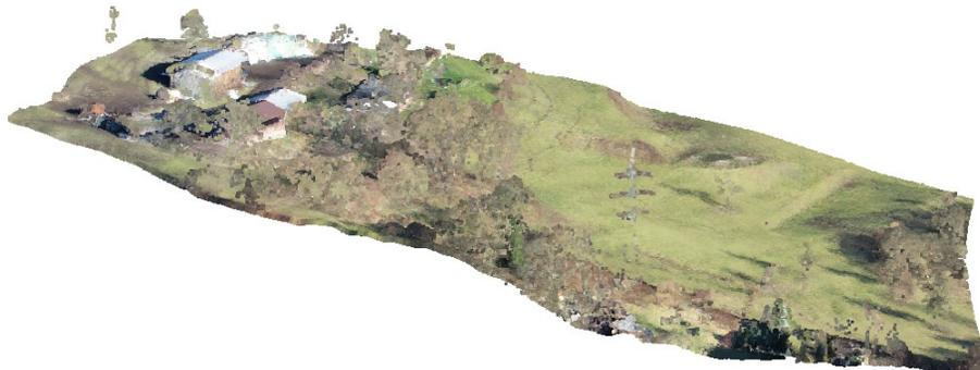
FIGURE 2 – Nuage de points 2 - la partie inférieure de la pente obtenue par le lidar
