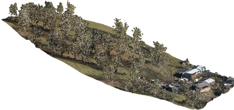
FIGURE 1 – Nuage de points 1 - partie supérieure de la pente obtenue par photogrammétrie
