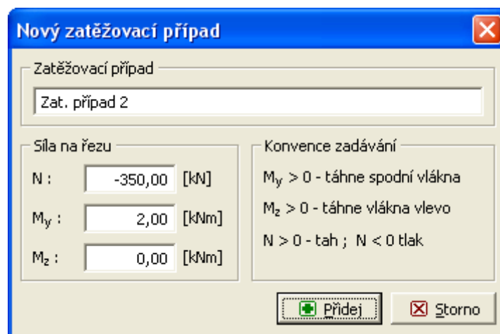
Okno pro zadání zatěžovacího případu
