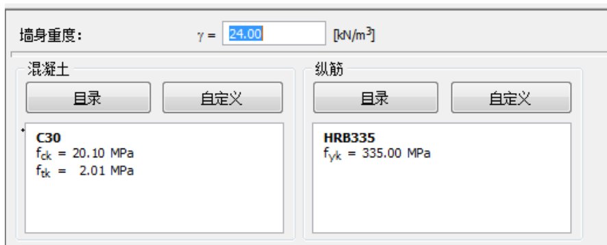
图 3.4 挡墙材料设置
