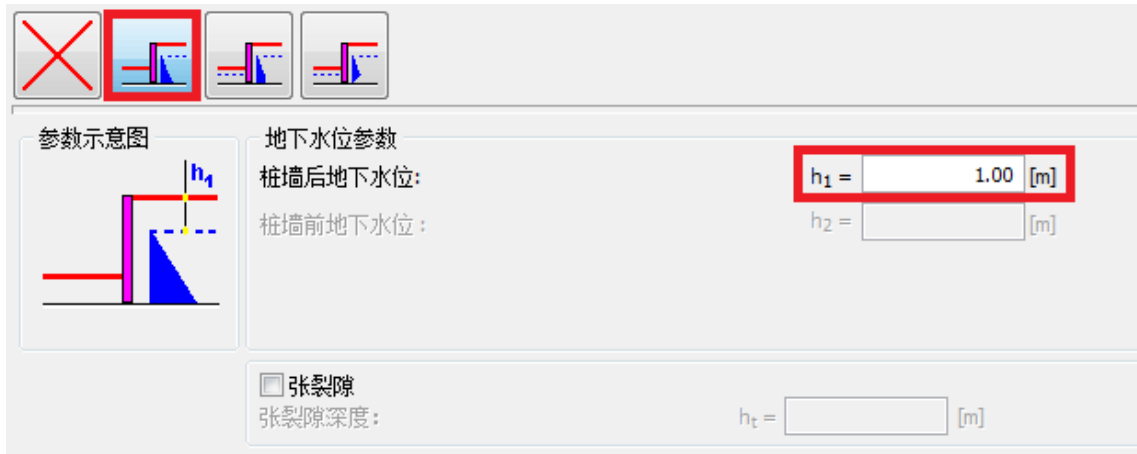
图 4.6 【地下水】设置——工况阶段[1]
