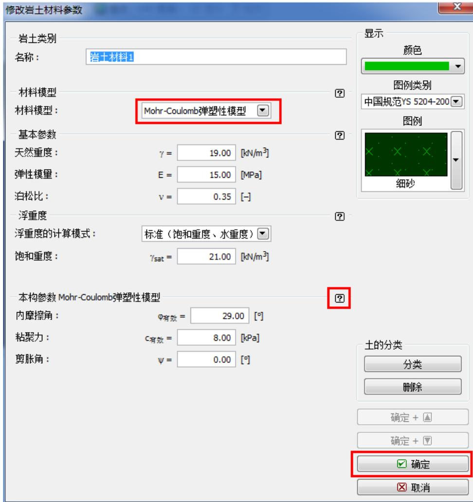
图 21.2 设置岩土材料参数
