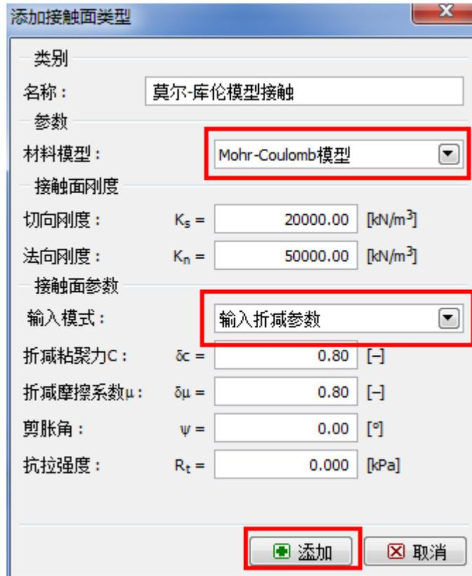
图 26.6 “添加接触面类型”对话框
