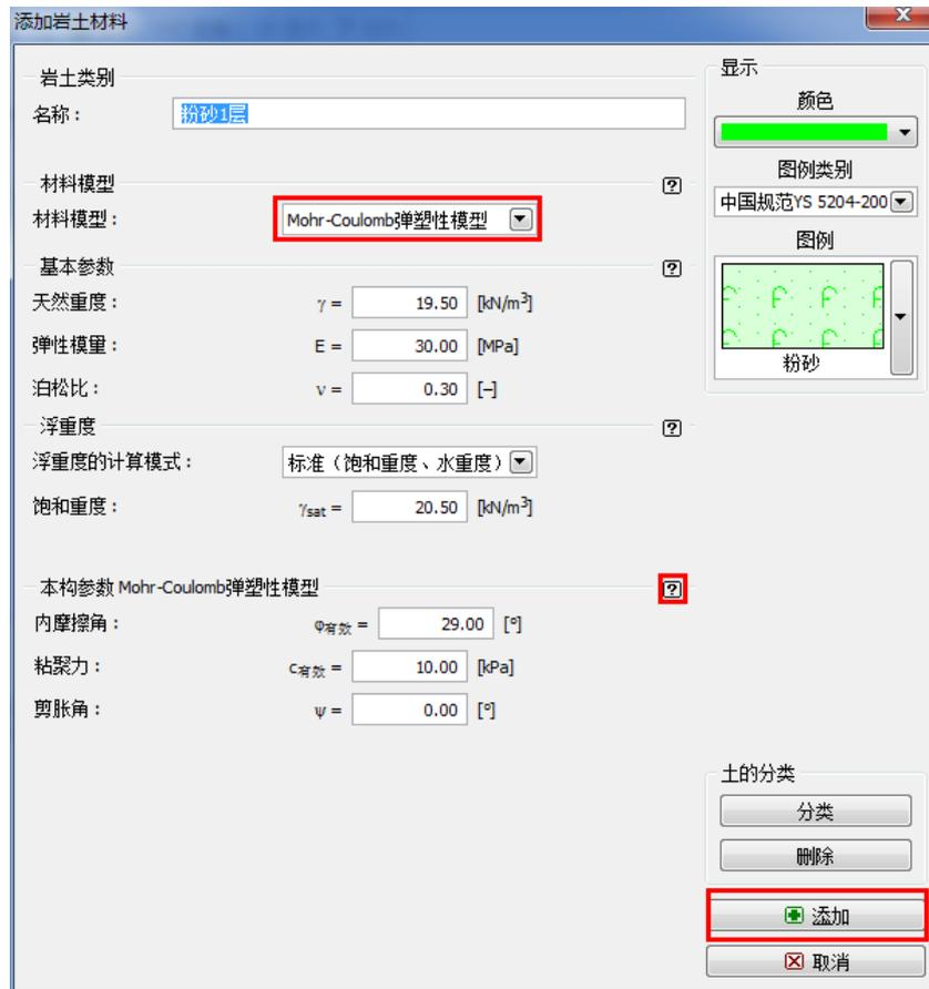
图 26.4 “添加岩土材料”对话框
