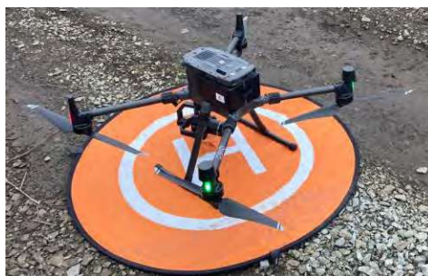
Obr. 2: Dron DJI M300 RTK s kamerou pro fotogrammetrické měření
