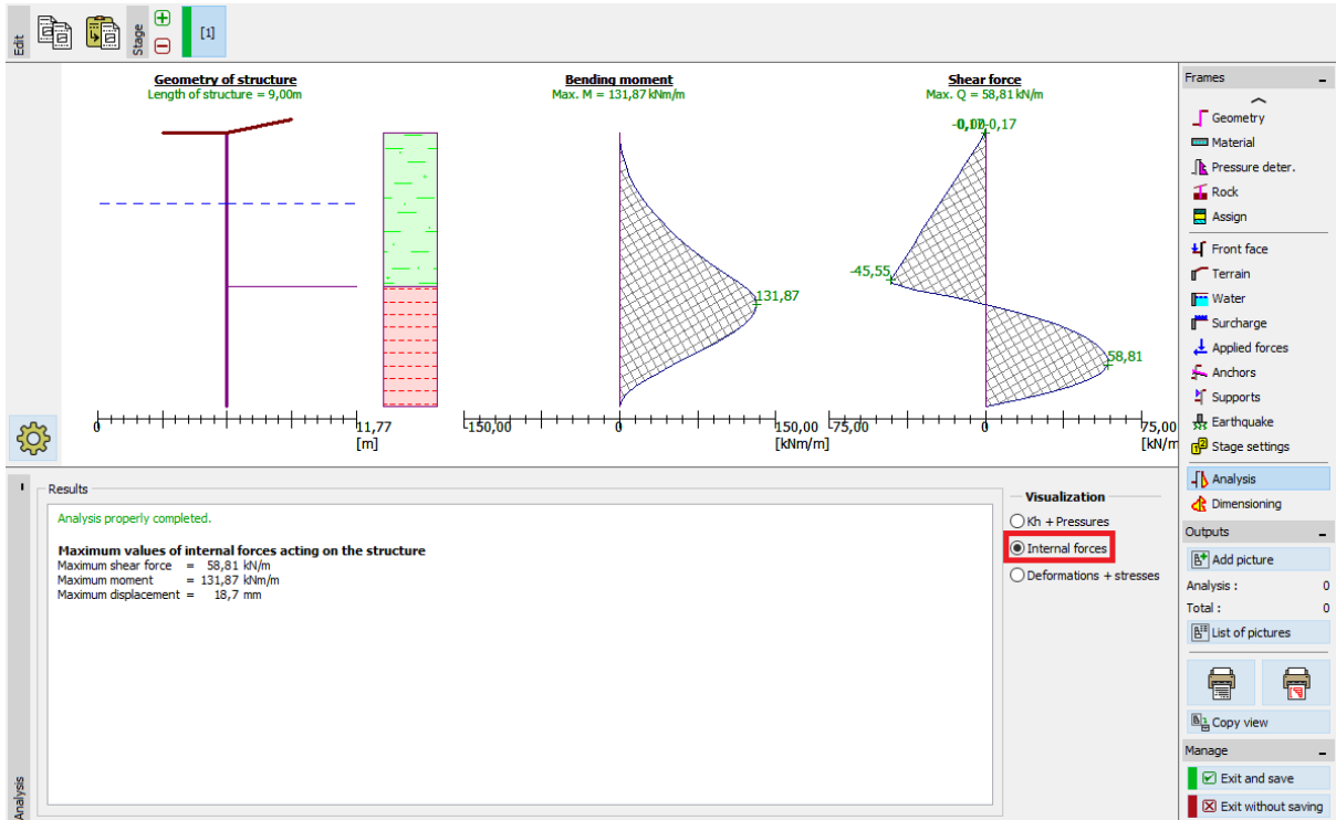
„Megtámasztó cölöp” program – „Számítás” menü - Igénybevételek
