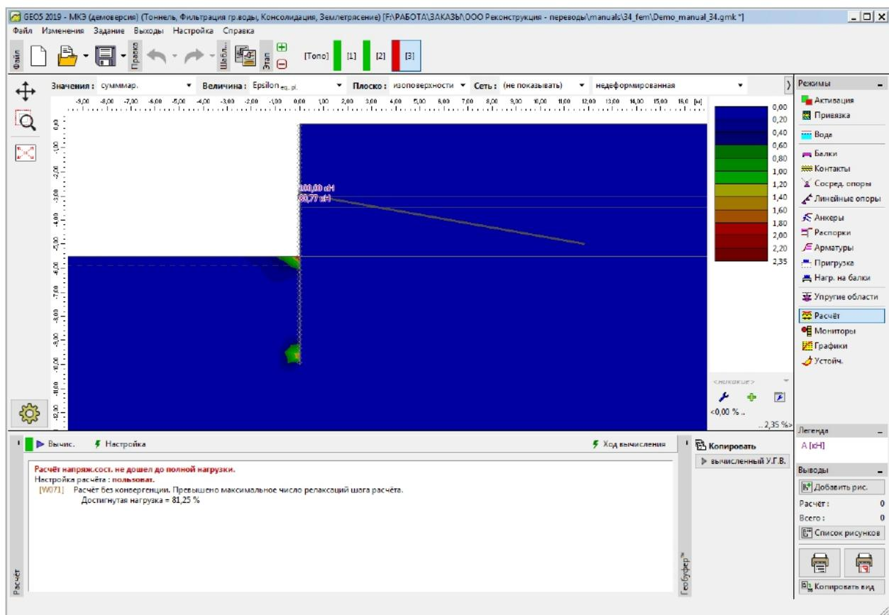
*Равновесие для полной нагрузки на третьем этапе проектирования не достигнуто – не происходит перераспределения пластических деформаций, расчет расходится*
