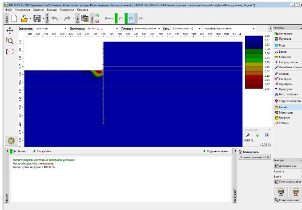
*Достижение равновесия с использованием упругой области, содержащей один элемент*
